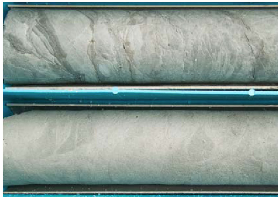
圖二 岩心中第三紀基盤岩之剪碎帶外觀。
