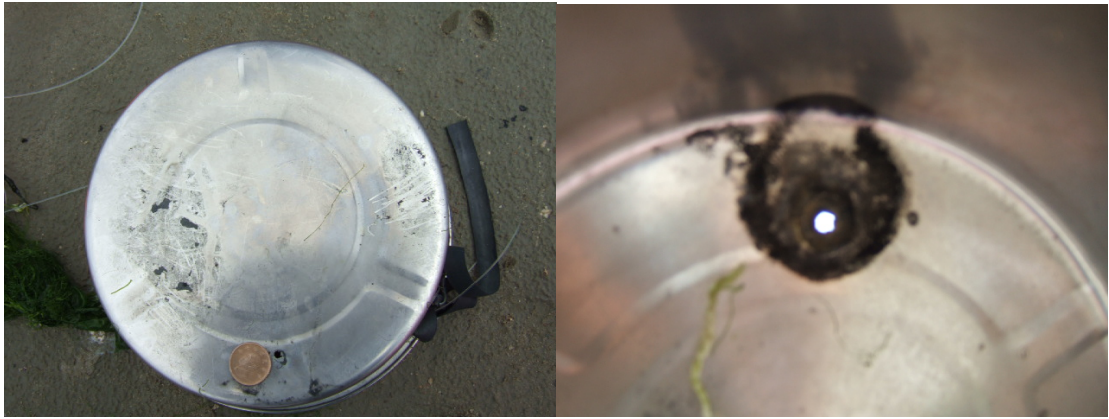
圖四 不鏽鋼在 B 池的腐蝕現象（左：外鍋，右：內鍋）
